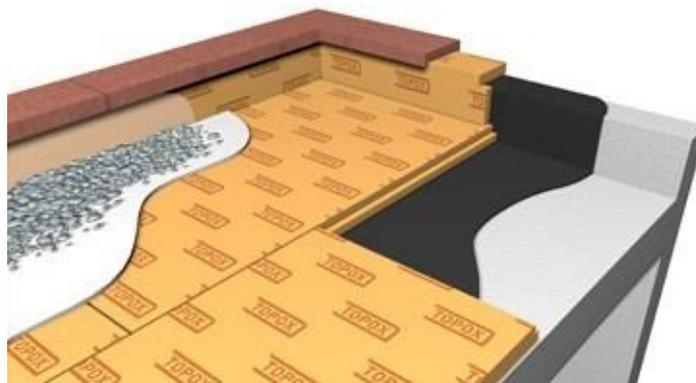
Imagen de una cubierta tipo invertida no transitable, con impermeabilización asfáltica, aislamiento térmico y protección pesada de grava.
