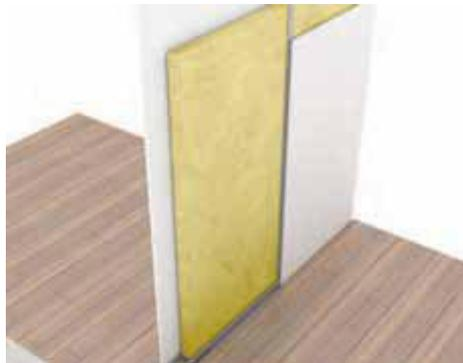
Imagen tipo de un tabique interior, con aislamiento térmico y acústico y placas de yeso laminado en ambas caras, sobre estructura de acero galvanizado.
