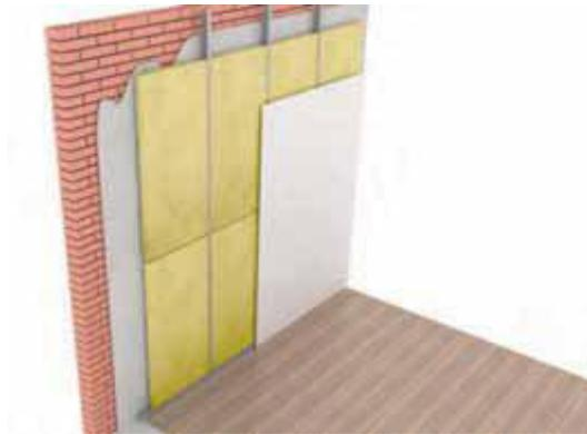
Imagen tipo de un cerramiento exterior de ladrillo, con aislamiento térmico y acústico interior y con un trasdosado de yeso laminado.
